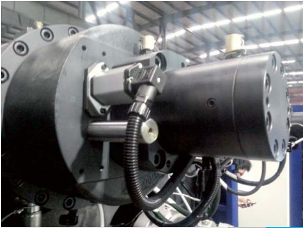
两板注塑机高压缸用上12系列电子尺
