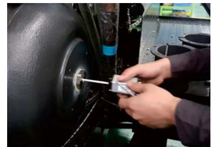
耐压外管无需与液压缸分离
