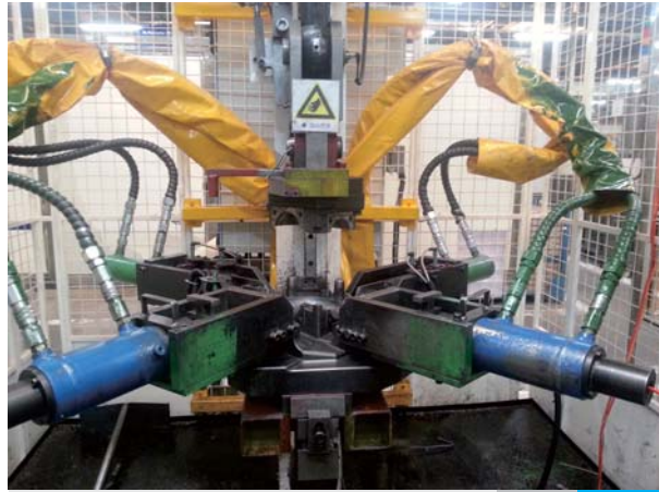
汽车排气管折弯机用上17系列电子尺
